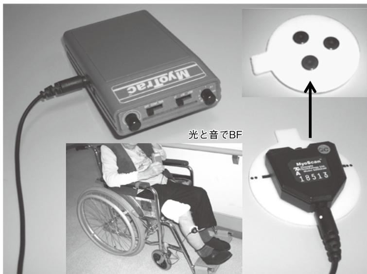
図1 コンパクトで携帯可能なBF機器と3極電極
